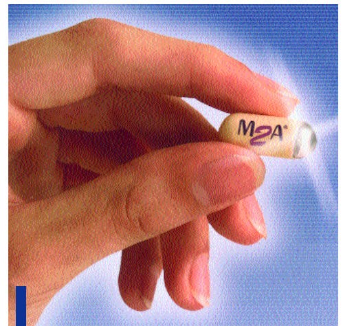
Die 26 x 11 mm grosse und 3,7g schwere Videokapsel M2A®.
