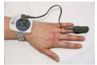
Fingerpulsoximeter mit Datenspeicher zur nächtlichen Sättigungsmessung oder für Belastungstests
