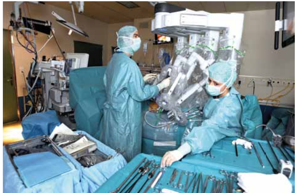
Beim DaVinci-System tragen die beweglichen Arme des Roboters Kamera und Instrumente.
