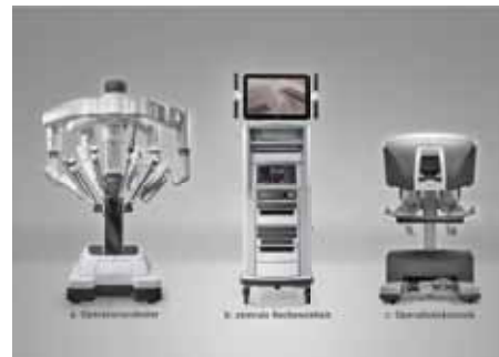
Abb. 1: Das DaVinci-System besteht aus dem Operationsroboter, zentraler Recheneinheit und Konsole.
